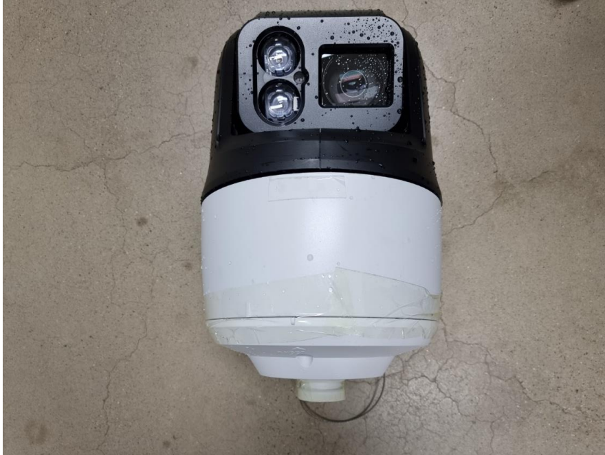
< 사진4. IPX6 시험 후 >
