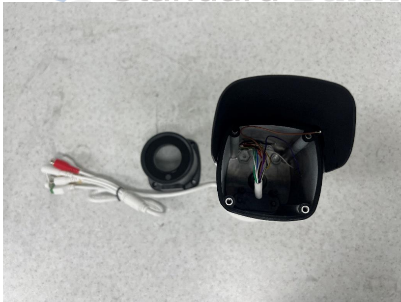
< 사진6. IPX6 시험 후 내부 >
