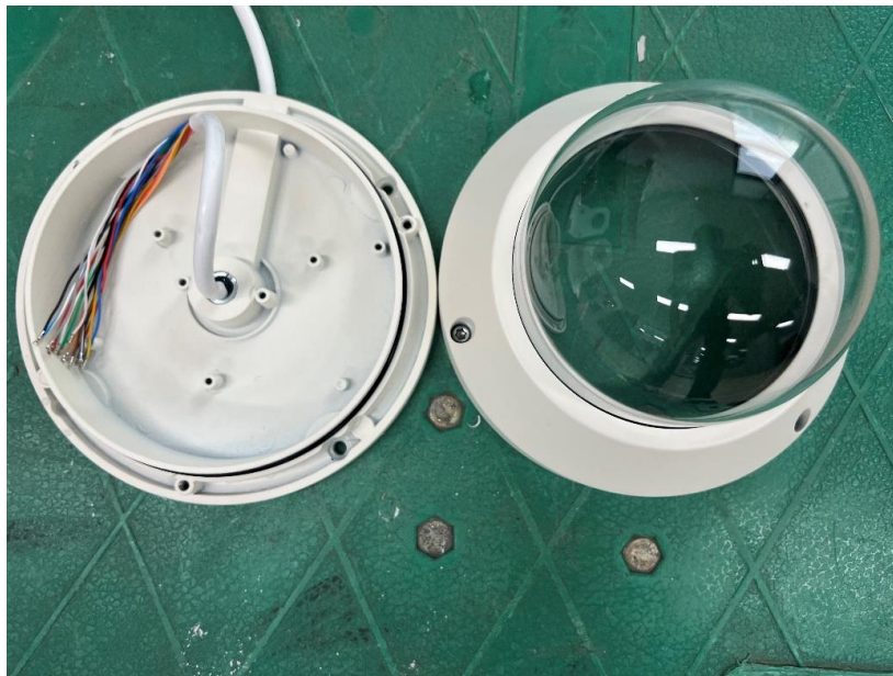
< 사진5. IPX6 시험 후 내부 >
