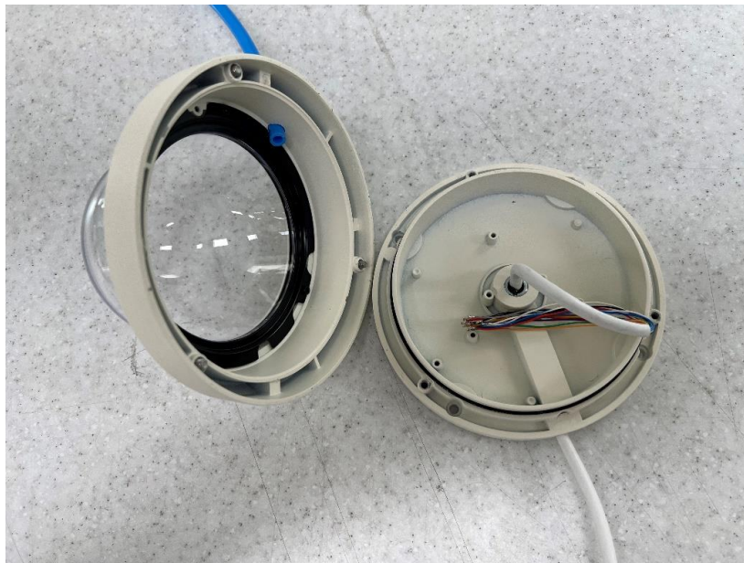
< 사진3. IP6X 시험 후 내부 >
