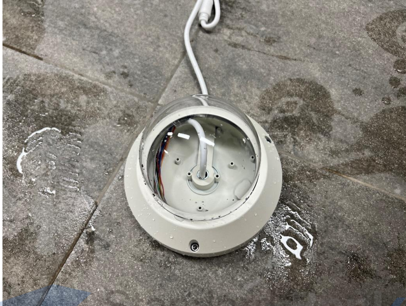
< 사진4. IPX6 시험 후 외부 >
